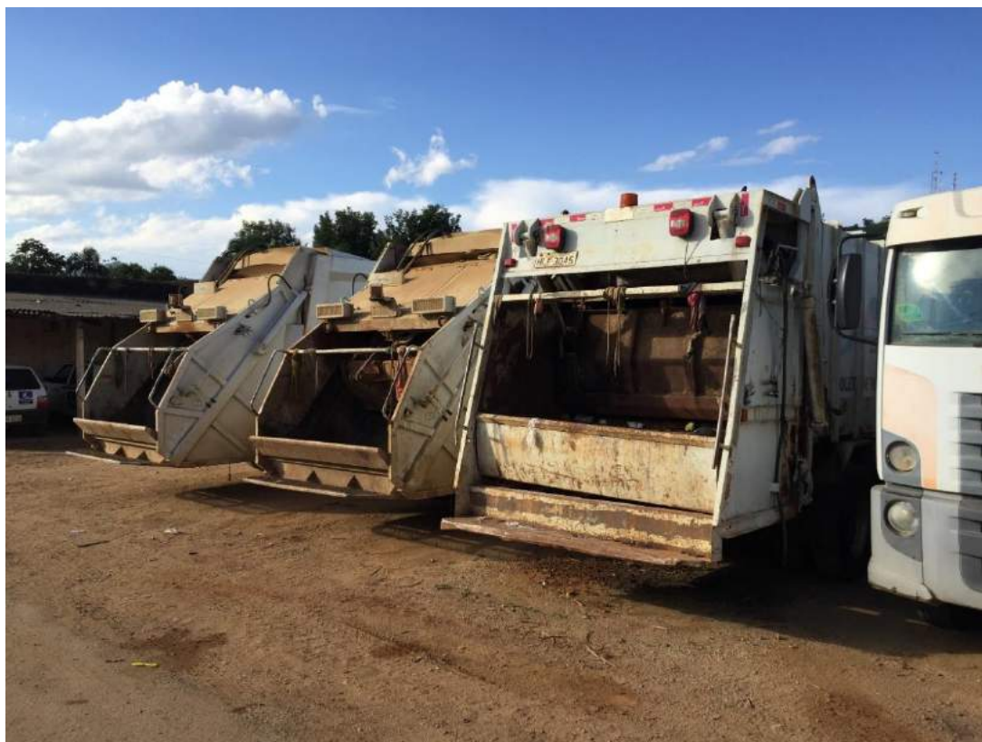
Figura 122 – Caminhões Compactadores utilizados na coleta e transporte de RDO e RCO
